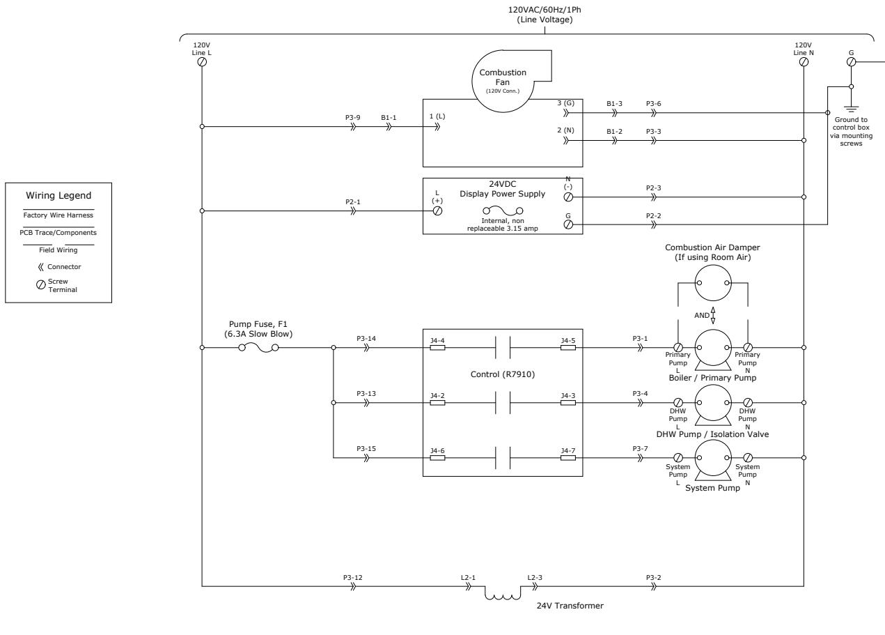
**Figure 30: 400-1000 Wire Diagram**
